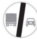
73 Fine del divieto di sorpasso fra i veicoli di massa a pieno carico superiore a 3,5 t
